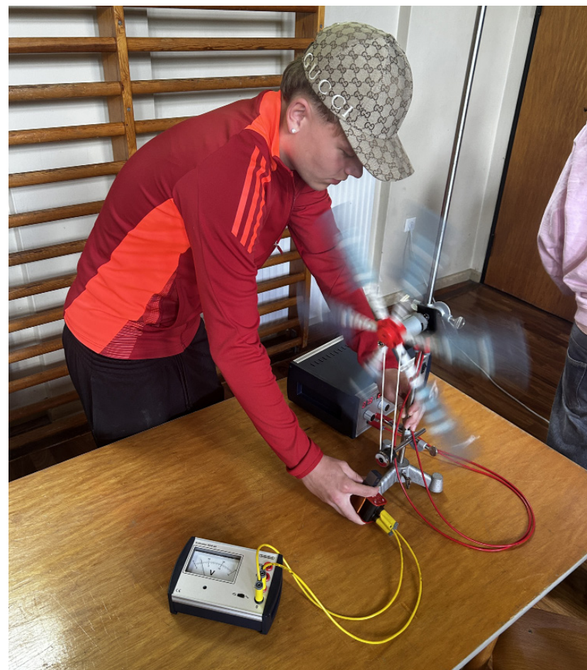
Linus, 9.b, viser, hvordan der genereres energi ved hjælp af en roterende magnet. Foto: Trine Flammig
